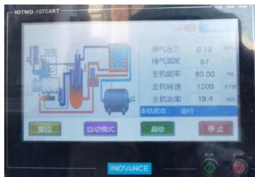
節能螺桿空氣壓縮機的操作介面
